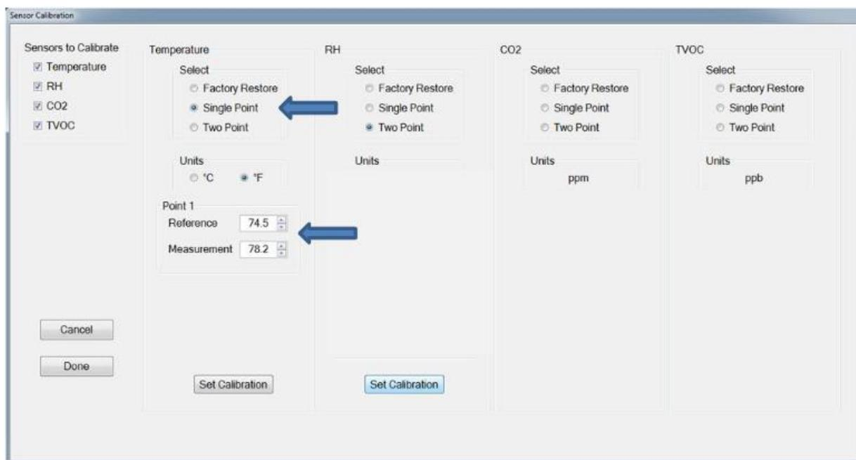
1. **Calibración o compensación de un punto** - Esta función permite una compensación de un solo punto en el caso de que sólo sea posible un punto calibración de referencia. (Un ejemplo sería la temperatura del aire ambiente cuando no se dispone de una cámara ambiental; véase la imagen anterior).
