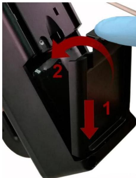
Paso 6 – Asiente la tapa del compartimento de la batería en la ranura inferior y empújela hacia dentro hasta que el pestillo de bloqueo haga clic. El tornillo de seguridad de puede volver a instalar con un destornillador o se puede quitar para utilizarlo como reemplazo opcional de la batería.
