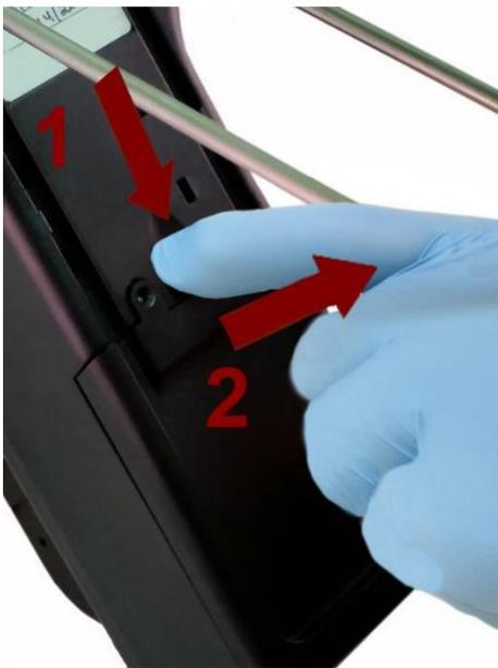
Paso 3 – Empuje el pestillo hacia abajo mientras tira de la tapa del compartimento de la batería hacia fuera
