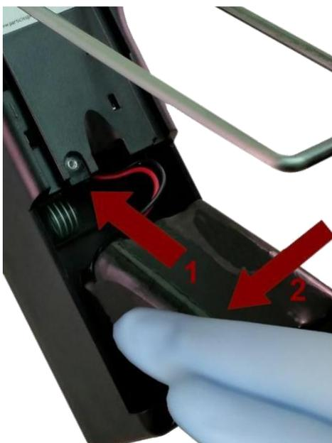
Paso 5 – Empuje la batería dentro del compartimento con un movimiento ascendente hasta que la parte inferior de la batería se despeje del borde de compartimento y caiga.
