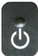
La tecla externa de encendido y muestreo de un solo toque en el mango encenderá y apagará el dispositivo y encenderá y apagará el muestreo.
