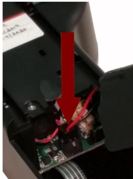
Paso 4 – Inserte el enchufe de conexión de la batería en el correspondiente de la tarjeta PCB del compartimento de la batería
